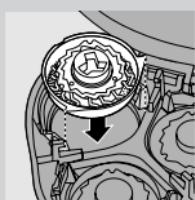
**3** Pasang kembali kepala pencukur ke dalam unit pencukur. Pasang kembali rangka penahan ke dalam unit pencukur dan pusingkan kunci ke arah jam.
