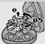
**4** 取下剃须刀头，在剃须刀头部件上装上新刀头。将固定架装回剃须刀头部件，顺时针转动并锁住。
