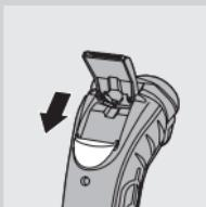
**1 向下推动滑块，打开修发器。**
