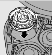
**3** 将剃须刀头放回剃须刀头部件。将固定架放回剃须刀头部件，顺时针转动并锁住。
