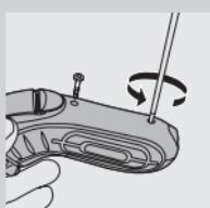
**2** 让剃须刀运转到停止为止, 拧开胡茬储藏室中的两个螺丝, 然后将其取下。
