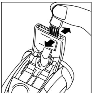
ご使用ごとに、必ずスイッチをOFFにしてからクリーニングブラシで刃の部分を軽く掃除してください。
