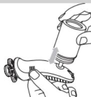
**3** Вставте випускний отвір пляшки з кондиціонером в отвір наповнення картриджжа.
