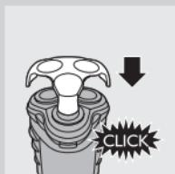
► Setzen Sie die Schutzkappe auf den Rasierer, um Beschädigungen an den Scherköpfen zu vermeiden.
