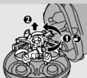
**2** Drücken Sie die Entriegelungstaste, und öffnen Sie die Schereinheit.
