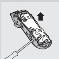
**6** Entfernen Sie die Rückseite der versiegelten Elektronikeinheit mit einem Schraubendreher.
