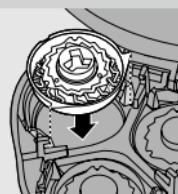
**4** Entnehmen Sie die Scherköpfe, und setzen Sie neue Scherköpfe in die Schereinheit ein. Setzen Sie den Scherkopfhalter wieder in die Schereinheit, und drehen Sie die Verriegelung im Uhrzeigersinn fest.
