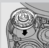
**4** Fjern skjærehodene og sett inn nye i skjæreenheten. Sett holderrammen tilbake i skjæreenheten, og vri låsen med klokken.
