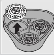
**3** Ruotate la rotella in senso antiorario (1) e togliete la struttura di supporto (2).
