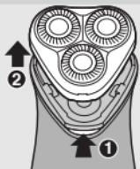
**2** Cihazla birlikte verilen fırçayı kullanarak önce cihazın üst kısmını temizleyin.
