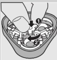
**5** Tespit çerçevesini tıraş ünitesine (1) yerleştirin ve çarkı, saat yönünde (2) çevirin.
