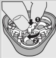
**5** Replacez la molette (1), puis faites-la tourner dans le sens des aiguilles d'une montre (2).
