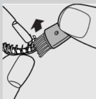
**4** Rimuovete le lame e le relative protezioni e puliteli con lo spazzolino in dotazione.
