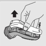
Não volte a ligar a máquina de barbear à corrente depois de a bateria ter sido removida.
