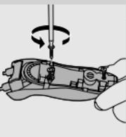
**6** Frigør motorenheten med en skruetrækker.
