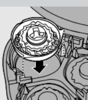
Die Vorsprünge an den Scherköpfen müssen genau in die Aussparungen der Schereinheit passen.
