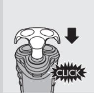
**4 Pulite il rasoio (vedere il capitolo "Pulizia e manutenzione").****5 Dopo l'uso, mettete sempre l'apposito cappuccio di protezione sul rasoio per evitare danni alle testine di rasatura.****Rifinitura**
