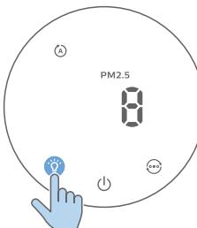
Pomoću senzora za svjetlo upravljačka ploča može se automatski uključiti, isključiti ili prigušiti ovisno o osvijetljenosti okoline. Kada je okolina tamna, upravljačka ploča bit će isključena ili prigušena. Za uključivanje svjetla dodirnite bilo koji gumb.
