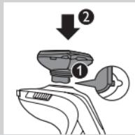
**3** 将新 RQ12 剃须刀头部件的凸缘插入剃须刀顶部的槽内 (1)。然后按下剃须刀头部件 (2) 以将其安装在剃须刀上（可听到“咔哒”一声）。
