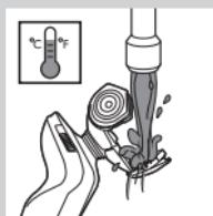
**2** Поочередно откройте три бритвенные головки и промойте все три бритвенные головки и все три отсека для волос под струей горячей воды в течение 30 секунд.
