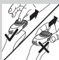
注意： 抓住修剪梳的中心位置，将其抽离胡须造型器附件。请勿拉拔修剪梳的侧面。
