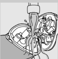
**3** Làm sạch bộ phận cạo và khoang chứa râu tóc bằng cách rửa chúng dưới vòi nước nóng ( $60^{\circ}\text{C}$ - $80^{\circ}\text{C}$ ).
