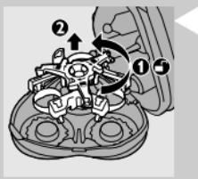
**1** 打開電鬍刀組，將鎖扣逆時針方向轉動
