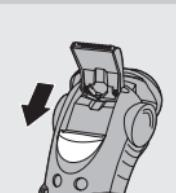
**1** 向下推动滑块，打开修发器。
