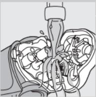
**3** Làm sạch bộ phận cạo và khoang chứa râu tóc bằng cách rửa chúng dưới vòi nước nóng.
