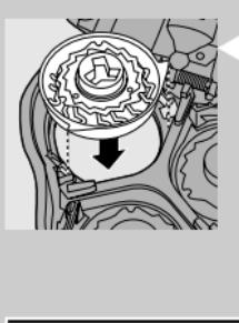
**3** 將電鬍刀刀頭裝回電鬍刀組。將固定架裝回電鬍刀組上，並以順時針方向轉動鎖扣。
