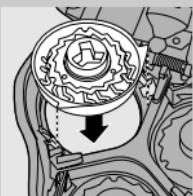
**4** Tanggalkan kepala pencukur dan gantikan yang baru di dalam unit pencukur. Pasang kembali rangka penahan ke dalam unit pencukur dan pusingkan kunci ke arah jam. Pastikan bahagian unjuran kepala pencukur muat dipasangkan ke dalam lubang-lubang yang dikhaskan.
