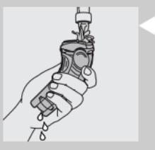
► Nước có thể rò rỉ từ đầu cắm ở phần dưới của máy khi bạn rửa máy. Điều này là bình thường và không nguy hiểm bởi vì tất cả các bộ phận điện tử đều được đóng kín trong lớp vỏ bảo vệ bên trong máy.
