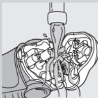
**3** Rengjør skjæreenheten og skjeggkammeret ved å skylle begge deler under rennende, varmt vann en stund.
