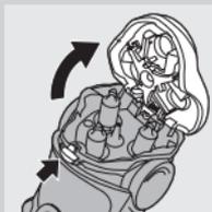
**1** Slå av barbermaskinen, ta støpselet ut av stikkontakten og ta ledningen ut av barbermaskinen.
