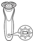
Charge rapide : Après une recharge de 5 minutes environ, le rasoir fournit suffisamment d'énergie pour un rasage. À ce moment, le témoin de charge de la pile cesse de clignoter rapidement et commence à clignoter lentement.
