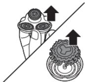
Remarque : Ne nettoyez qu'une lame et une grille à la fois, car elles sont assemblées par paires. Si, par erreur, vous placez une lame dans la mauvaise grille de rasage, plusieurs semaines peuvent être nécessaires avant de retrouver un rasage optimal.
