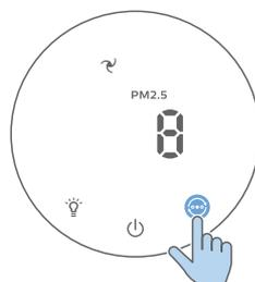
**Velocidade manual (vórtice e vórtice):** no modo manual, o purificador de ar funciona na Velocidade 1 ou na Velocidade 2.
