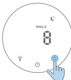
**Modo Sono (☾):** o purificador de ar funciona silenciosamente a uma velocidade reduzida. Depois de 3 segundos, o ecrã desliga-se.
