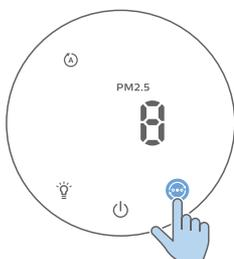
**Modo Automático (A):** o purificador de ar ajusta automaticamente a velocidade da ventoinha de acordo com a qualidade do ar ambiente.
