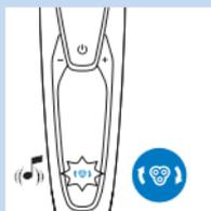
*Nota: Depois de substituir as cabeças de corte, tem de repor a máquina de barbear premindo o botão ligar/desligar durante 7 segundos.*
