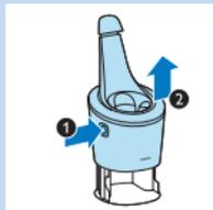
**1** Premete il pulsante sul lato del sistema SmartClean (1) ed estraete la parte superiore del sistema SmartClean (2).
