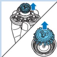
Retire o anel de retenção do respectivo suporte e repita este processo para os restantes anéis de retenção.
