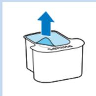
**3** Premete il pulsante sul lato del sistema SmartClean (1) ed estraete la parte superiore del sistema SmartClean (2).
