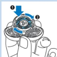
*Remarque : Tenez le support de la tête de rasage dans la main lorsque vous réinsérez les têtes de rasage et refixez les anneaux de fixation. Ne placez pas le support de la tête de rasage sur une surface lors de cette opération car vous risqueriez de l'endommager.*
