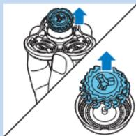
Extraiga el anillo de retención del soporte del anillo de retención y repita este proceso para los otros anillos de retención.
