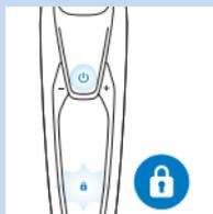
*Nota: potete disattivare il blocco da viaggio collegando l'apparecchio alla presa di corrente.*
