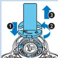
**2** Coloque o suporte do anel de retenção no anel de retenção (1), rode-o para a esquerda (2) e levante-o para fora da cabeça de corte (3).
