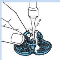
**3** Sciacquate il supporto della testina di rasatura sotto l'acqua calda corrente.
