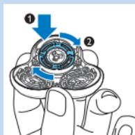
*Nota: Quando inserite le testine di rasatura e fissate gli anelli di arresto, tenete il portatestina e non posizionate su una superficie, onde evitare danni.*
