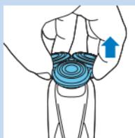
**2** Tire del soporte del cabezal de afeitado desde la parte inferior de la unidad de afeitado.
