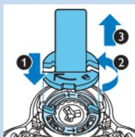
**2** Coloque el soporte del anillo de retención en el anillo de retención (1), gírelo en sentido contrario al de las agujas del reloj (2) y extráigalo del cabezal de afeitado (3).
