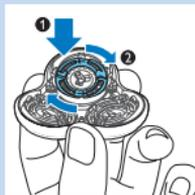
*Nota: Segure o suporte da cabeça de corte na sua mão quando voltar a inserir as cabeças de corte e voltar a fixar os anéis de retenção. Não pouse o suporte da cabeça de corte sobre nenhuma superfície ao fazer isto, pois pode causar danos.*
