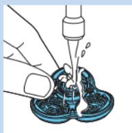
**3** Enjuague el soporte del cabezal de afeitado bajo el grifo con agua caliente.
