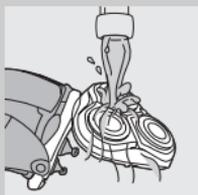
**3** Očistite jedinicu za brijanje i komoru za prikupljanje dlaka ispiranjem toplom vodom iz slavine.
