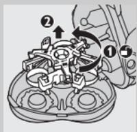
**1** Otvorite jединicu za brijanje, okrenite bravu u pravcu suprotnom od kazaljke na satu (1) i izvadite granični okvir (2).
