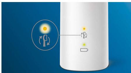
Чистящие насадки изнашиваются со временем, однако технология BrushSync отслеживает длительность и интенсивность использования насадки в этот период. Когда придет время заменить насадку, загорится индикатор, а зубная
