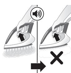
นอกจากนี้แล้ว ยังมีการป้องกันขั้นที่สองเพื่อป้องกันตะกรันจับเครื่องทำไอน้ำ ดังนี้ พิงก์ชันไอน้ำจะปิดการทำงาน หากไม่มีการทำความสะอาดคราบตะกรัน หลังจากสิ้นสุดการทำความสะอาดคราบตะกรัน พิงก์ชันไอน้ำจะถูกเปิดใช้งานอีกครั้ง โดยไม่คำนึงถึงประเภทของน้ำที่ใช้
