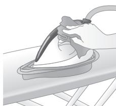
6 等待约 2 分钟，让产品完成除垢流程。除垢流程完成后，熨斗将停止发出蜂鸣音，除垢指示灯将停止闪烁。
