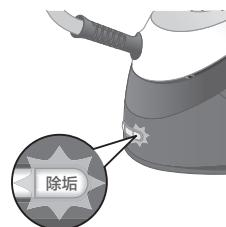
使用1至3个月后，除垢指示灯开始闪烁，产品开始发出蜂鸣音，表示您必须执行除垢流程。
