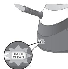
เมื่อใช้งานผ่านไป 1 - 3 เดือน ไฟเตือน ให้ขัดคราบตะกรันจะเริ่มกะพริบ และเครื่องเริ่มส่งเสียงเตือนให้คุณทราบว่าคุณต้องขัดคราบตะกรันตามขั้นตอน
