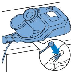
Hinweis: Sie können den Handstaubsauger auch aufladen, indem Sie den Adapter in die Steckdose stecken und den Magnetstecker in die Unterseite des Handstaubsaugers schieben.
