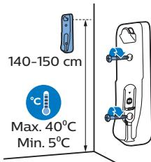
Wenn Sie das Gerät an der Wand-Ladestation laden und aufbewahren möchten, befestigen Sie die Ladestation mithilfe der mitgelieferten Schrauben an der Wand. Vergewissern Sie sich, dass sich die Ladestation 140-150 cm über dem Fußboden befindet. Achten Sie darauf, dass die Temperatur in dem Raum, in dem das Gerät aufbewahrt oder aufgeladen wird, zwischen 5 °C und 40 °C liegt.
