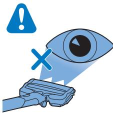
**Achtung: Blicken Sie nicht direkt in die LEDs der 360 °-Saugdüse und richten Sie die LEDs nicht auf die Augen anderer. Das LED-Licht ist sehr hell.**
