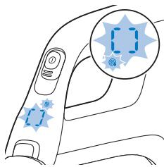
Reinigen Sie den Filter jedes Mal, wenn auf dem Display ein blinkendes Quadrat angezeigt wird und auch das orangefarbene Symbol für die Filterreinigung blinkt.
