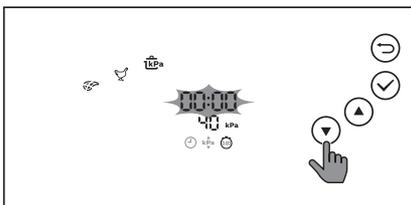
5 轻触
