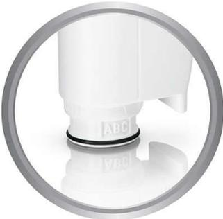
Les options du filtre à eau peuvent être réglées en fonction de la dureté de votre eau. Tournez simplement l'anneau de réglage sur le filtre à eau de l'Intenza+. Réglez-le sur A dans les régions où l'eau est douce, sur B si l'eau est moyennement dure (préréglage d'usine), et sur C si l'eau est dure. Ainsi, vous bénéficierez d'une protection optimale contre le calcaire et vos boissons auront un goût optimal.
