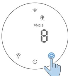
**Način rada Turbo (Ⓢ):** pročišćivač zraka radi pri najvišoj brzini.
