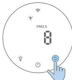
**Ručna brzina (☯ i Ⓢ):** u ručnom načinu rada pročišćivač zraka radi pri brzini 1 ili 2.
