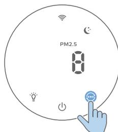
**Stanje mirovanja (☾):** pročišćivač zraka radi tiho pri maloj brzini. Zaslom se isključuje nakon 3 sekunde.
