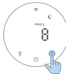
**Κατάσταση αναστολής λειτουργίας (⌚):** Η συσκευή καθαρισμού αέρα λειτουργεί αθόρυβα σε χαμηλή ταχύτητα. Μετά από 3 δευτερόλεπτα, η οθόνη σβήνει.
