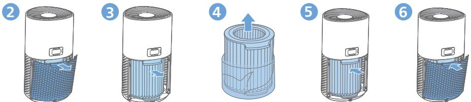
2 Τραβήξτε το πίσω κάλυμμα και αφαιρέστε το από τη συσκευή.
