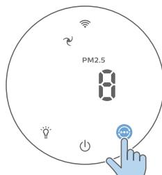
**Ručna brzina (↷ i ↸):** U ručnom režimu prečišćivač vazduha radi brzinom 1 ili brzinom 2.
