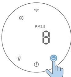
**Automatski režim (Ⓐ):** Prečišćivač vazduha automatski prilagođava brzinu ventilatora u skladu sa kvalitetom vazduha u okruženju.
