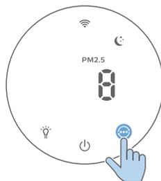
**Modalità Sleep (☾):** il purificatore d'aria funziona silenziosamente a velocità molto ridotta. Dopo 3 secondi, lo schermo si spegne.
