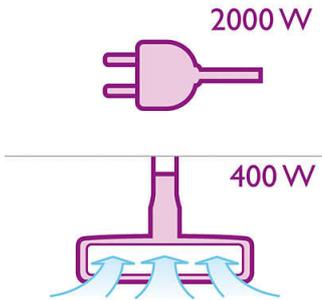
O poderoso motor de 2000 Watts gera uma potência de sucção máxima de 400 Watts para resultados de limpeza perfeitos.
