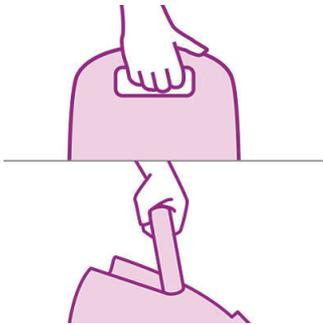
Este aspirador tem duas pegadas de transporte. Quando se encontra sobre as rodas, pode utilizar a pega no topo do aspirador para o movimentar facilmente quase sem dobrar as costas. A segunda pega, na parte frontal, permite o seu transporte confortável na posição vertical.
