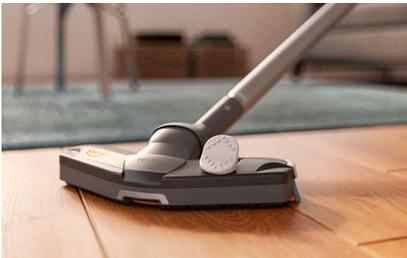
La brosse TriActive réalise 3 actions de nettoyage à la fois : 1) Elle écarte les fibres du tapis avec sa semelle spécialement conçue pour aspirer la poussière en profondeur. 2) Elle aspire les grosses particules grâce à sa grande ouverture à l'avant. 3) Elle balaie la poussière et les saletés le long des meubles et des murs avec ses deux brosses latérales.
