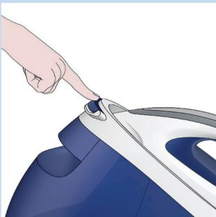
**4** Verriegeln Sie das Bügeleisen auf der Abstellfläche, indem Sie die Transportverriegelung in der vorgesehenen Position einrasten lassen.
