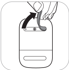
1. ถอดแผ่นยางออกจากฐานของแท่นมอเตอร์
