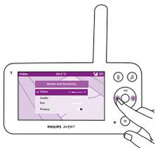
Pour sélectionner différents niveaux de sensibilité en fonction des différents modes, appuyez sur la partie gauche ou droite du bouton de commande.
