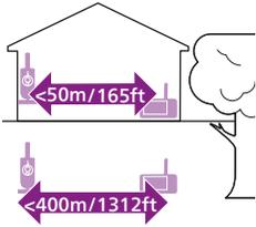
La portée maximale est de 50 mètres en intérieur et de 400 mètres en extérieur. La portée de l'écoute-bébé varie en fonction de l'environnement et des facteurs d'interférence. Les matériaux mouillés et humides provoquent tellement d'interférences que la perte de portée peut être totale.
