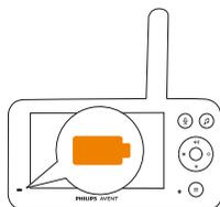
Le voyant d'état de la batterie s'allume en orange pour indiquer que l'appareil est en charge.
