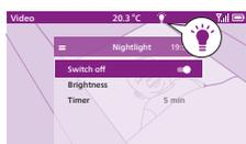
Lorsque la veilleuse est allumée, l'écran affiche une icône en forme d'ampoule dans la barre d'état.
