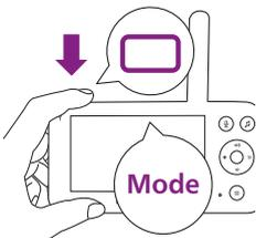
Lorsque l'écoute-bébé est allumé, appuyez sur le bouton de mode situé en haut à gauche de l'unité parents, puis appuyez sur la partie supérieure ou inférieure du bouton de commande pour passer d'un mode à l'autre. Pour sélectionner le mode souhaité, appuyez sur le bouton de confirmation.
