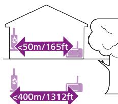
Radni domet je do 50 metara / 165 stopa u zatvorenom prostoru i 400 metara / 1312 stopa na otvorenom. Radni domet monitora za dijete varira ovisno o okruženju i čimbenicima koji uzrokuju smetnje. Mokri i vlažni materijali uzrokuju toliko smetnji da je gubitak dometa do 100 %.
