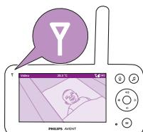
Kad su roditeljska jedinica i jedinica za dijete povezane, indikator veze na roditeljskoj jedinici svijetli bijelo, a na zaslonu se prikazuje jedna ili više crtice za jačinu signala.
