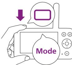
Dok je monitor za dijete uključen, pritisnite tipku načina rada u gornjem lijevom dijelu roditeljske jedinice, pritisnite gornji ili donji dio tipke za upravljanje za prebacivanje između tih različitih načina rada, a zatim pritisnite tipku za potvrdu za odabir željenog načina rada.
