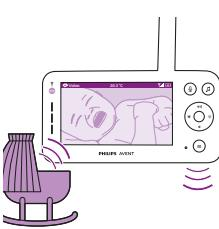
Kada jedinica za dijete otkrije zvuk, odmah se uključuje razina svjetla zaslona i zvuka roditeljske jedinice. Videozapis i zvukovi prenose se roditeljskoj jedinici i indikatori razine zvuka zasvijetle u bijeloj boji. Sve dok se ne prepozna nikakav zvuk, indikatori razine zvuka ostaju isključeni.
