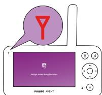
Zaslon će se uključiti, na zaslonu će se prikazati Philipsov emblem, a indikator veze počet će svijetliti crveno. Roditeljska jedinica počinje tražiti jedinicu za dijete.
