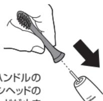
ブラシヘッドの毛先がハンドルの正面を向くように、ブラシヘッドの向きをそろえ、ブラシヘッドが止まるまで金属シャフトにヘッドをしっかりと差し込んで取り付けます。
