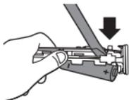
6. 充電電池の底と黒い枠の間にマイナスドライバーの先を差し込み、充電電池と緑色の回路基板の接続部にある金属タブを壊します。これで黒い枠から充電電池の底が外れます。
