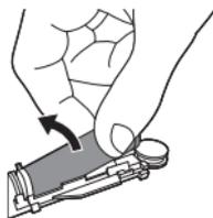
5. 充電電池と内部部品の底の黒い枠との間にマイナスドライバーの先を入れ、こじ開けて充電電池を離し、黒い枠を壊します。
