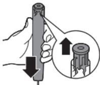
7. 充電電池をハンドル内部部品から引き出し、もう一方の充電電池タブを引き出して取り外します。
