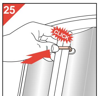
Na ca. 10.000 uren (vele jaren normaal gebruik) is het aan te bevelen de buislampen te vervangen.
