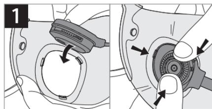
將風扇的一側壓入外層口罩的風扇環框中，確定環框上的三個扣鉤固定在風扇上。
