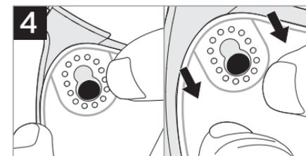
先將濾片 8 字形扣環上的大孔套入外層口罩內側的固定扣，然後向內拉，讓固定扣卡入 8 字形扣環的小孔。
