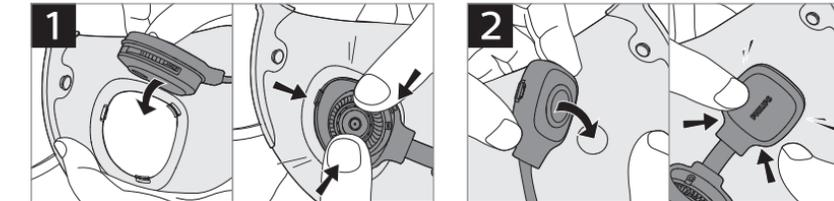
电动风扇一侧压入口罩彩壳上的风扇环,确保环上的三个卡钩都扣住风扇。
