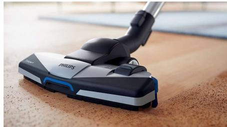
La brosse TriActive+ réalise 3 actions de nettoyage à la fois. La large ouverture à l'avant aspire les particules de grande taille, tandis que la semelle spécialement conçue élimine la poussière au plus profond des tapis et moquettes. Les canaux d'air et les brossettes des deux côtés de la brosse aspirent la poussière et la saleté le long des murs ou des meubles.
