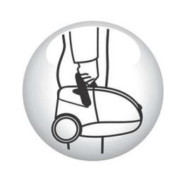
这款吸尘器具有两个搬运提手。平放使用时，您只要稍稍弯腰，通过顶部的提手即能轻松地移动吸尘器。借助产品正面的第二个提手，您可以轻松方便地将吸尘器直立搬动。
