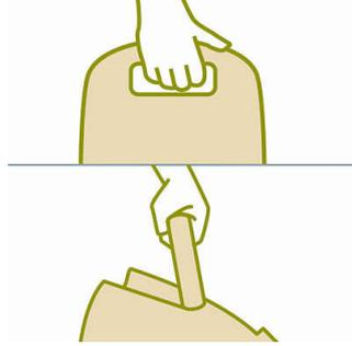
这款吸尘器具有两个搬运提手。平放使用时, 您只要稍稍弯腰, 通过顶部的提手即能轻松地移动吸尘器。借助产品正面的第二个提手, 您可以轻松地方便地将吸尘器直立搬动。
