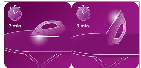
Le fer s'éteint automatiquement lorsqu'il n'est pas utilisé. S'il est posé sur son talon, il s'éteint au bout de 3 minutes. S'il reste sur sa semelle, il s'éteint au bout de 2 minutes.
