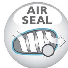
Cet aspirateur a été conçu de telle sorte que tout l'air aspiré passe à travers le filtre EPA 12 (filtration à 99,5 %) avant d'être évacué. Aucune échappatoire possible !
