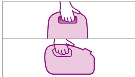
Ovaj usisivač nema jednu, već dve drške za nošenje. Kada je na točkovima, sa gornje strane se nalazi drška koja vam omogućava da jednostavno pomerate usisivač uz veoma malo savijanja. Druga drška sa prednje strane aparata omogućava vam da ga udobno nosite u uspravnom položaju.
