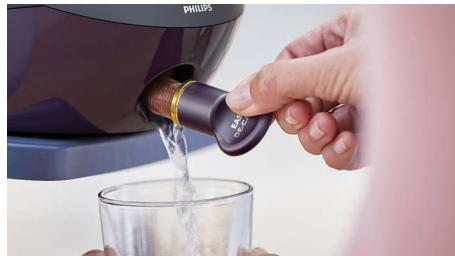
Z rednim odstranjevanjem vodnega kamna boste zaščitali svoj likalnik, podaljšali njegovo življenjsko dobo in zagotovili najučinkovitejši izpust pare. Naš vrhunski sistem Easy De-Calc Plus neprekinitno zbira vodni kamen, indikator in zvočni signal pa vas obvestita, ko morate posodo izprazniti. Odstranite vtič in počakajte, da voda in delci vodnega kamna iztečejo.
