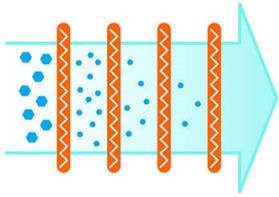
過濾系統包括四個獨立過濾層。這可以確保吸附吸塵機內部的所有灰塵。
