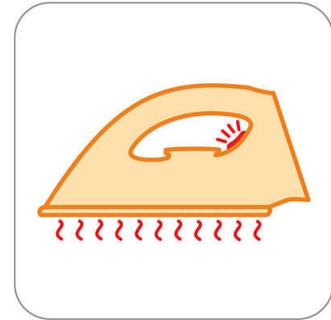
Die Temperaturanzeige geht an, wenn das Bügeleisen aufgeheizt wird, und geht wieder aus, sobald die Bügelsohle die eingestellte Temperatur erreicht hat.
