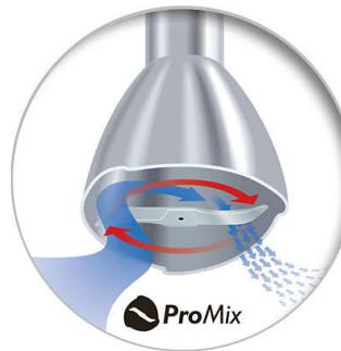
Technologie Philips ProMix vyvíjená ve spolupráci s prestižní Univerzitou Stuttgart je unikátní, pokročilou technologií, která používá trojúhelníkový tvar k vytvoření optimálního toku jídla a poskytuje vyšší výkon pro rychlejší a konzistentnější mixování.
