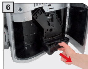
Wyciągnąć zbiornik na zużyte płyny, opróżnić go i umyć.
