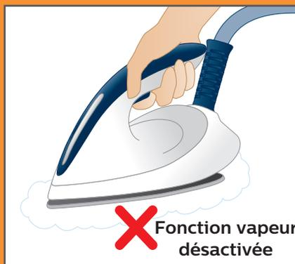
La fonction vapeur est automatiquement désactivée si le détartrage n'est pas effectué.
