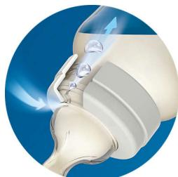
Naš ventil za sprječavanje kolika osmišljen je da drži zrak dalje od bebinog trbušića radi smanjenja kolika i nelagode. Dok se beba hrani, ventil ugrađen u sisač savija se i omogućava prolazak zraka u bočicu kako bi se spriječilo stvaranje vakuma te ga usmjerava prema donjem dijelu boćice. Zadržava zrak u boćici i dalje od bebinog trbušića radi smanjenja kolika i nelagode.
