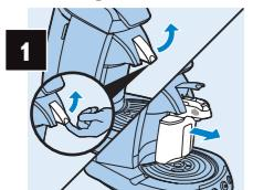
Levante la palanca y retire la unidad del depósito de leche del aparato.
