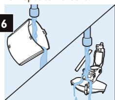
Si no va a hacer espuma con la leche inmediatamente después, enjuague el depósito de leche, la tapa del depósito de leche y el tubo de leche bajo el grifo de agua caliente antes de 30 minutos después del uso.
