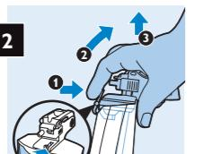
Presione la palanca de liberación de la tapa, incline la tapa del depósito de leche ligeramente y tire de ella hacia arriba para extraerla del depósito de leche.
